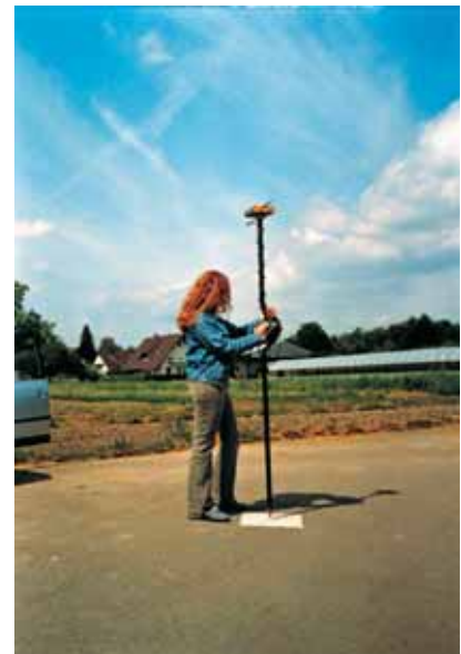
Abb. 4: Messung der Passpunkte mit GPS
