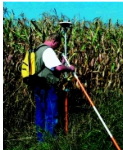
*Punktaufnahme mit Hilfe des GPS*
