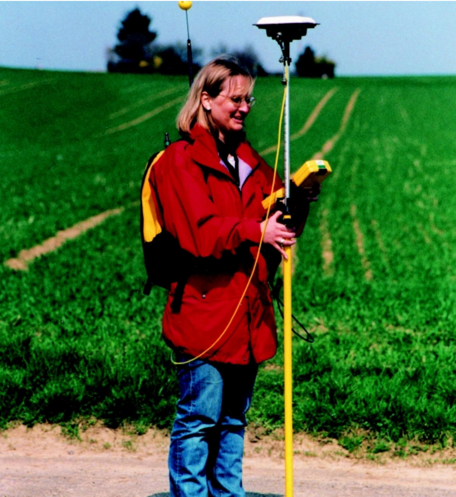
*Vermessung mit Hilfe des GPS (Global position system)*
