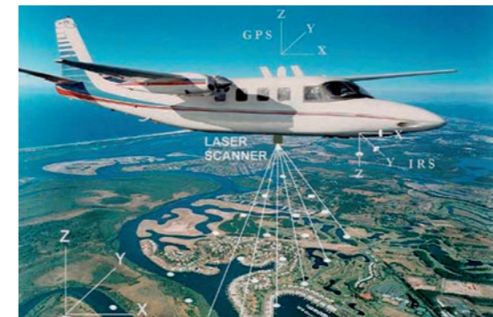
Flugzeug mit Laserscanner
